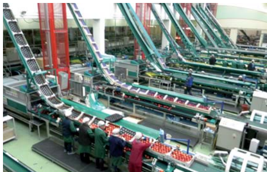
L'area dedicata al confezionamento è stata completamente rinnovata all'ultimo stato della tecnica nel 2008 e si compone di 16 linee di imballaggio, con una capacità media di 40 tons/ora
